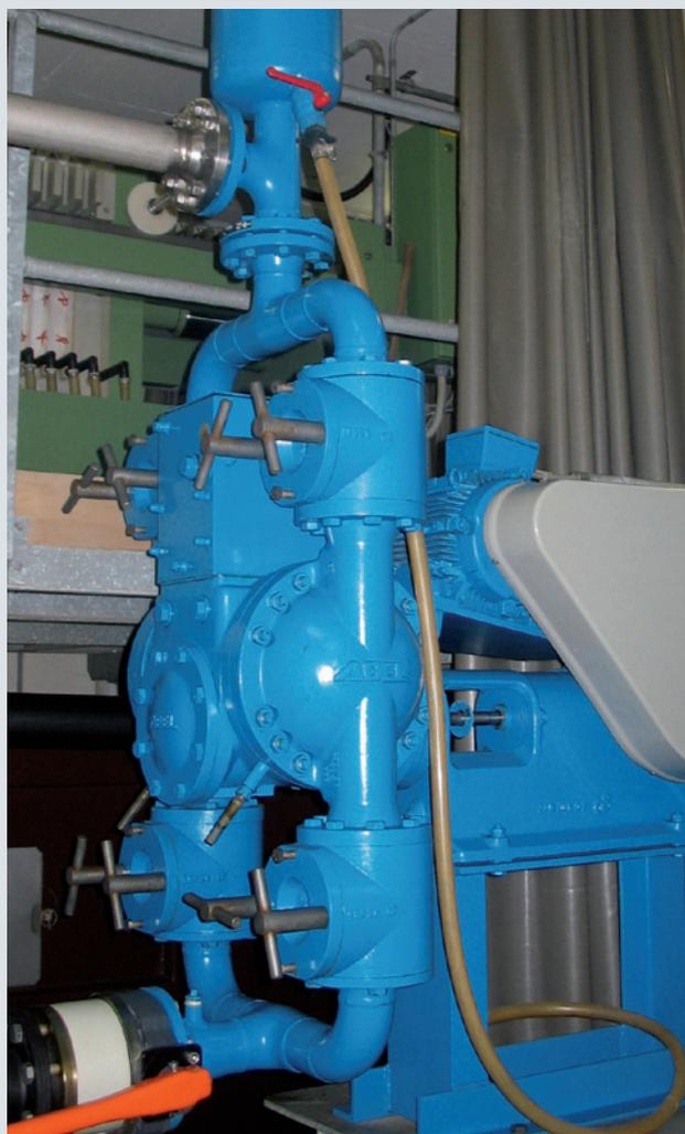
Corps de soupape avec couvercle d'accès et détecteur de fuite des membranes
