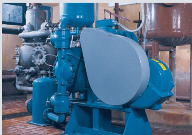
Construction stable, solide. Pompe à membrane et piston ABEL CM pour l'alimentation de filtres presses.
